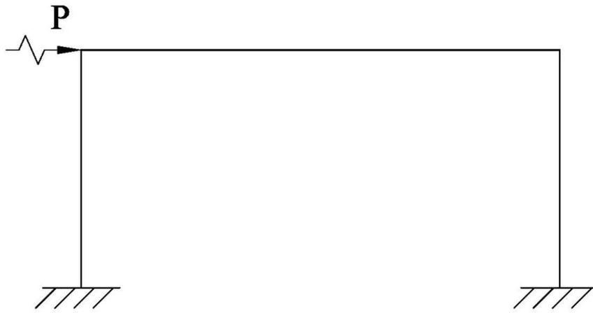
Рисунок 8 – Расчетная схема рамы при вынужденных колебаниях
