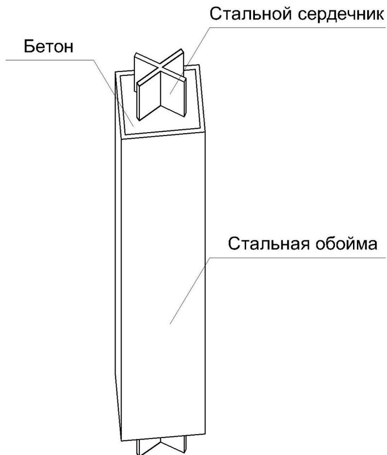
Рисунок 1 – Безизгибный элемент связи
