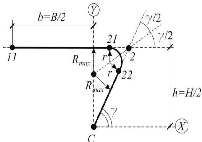
Рисунок 2 – Верхняя половина Z-образного сечения с закруглением
