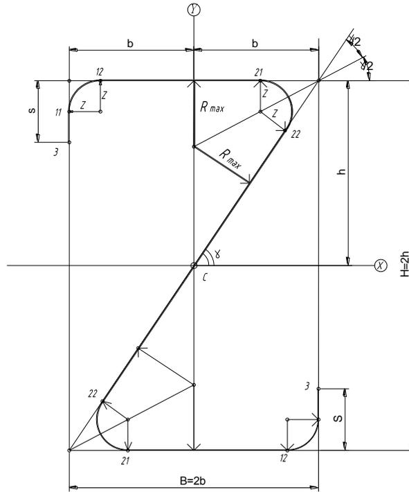
Рисунок 4 – Z-образное сечение с отбортовкой и с закруглением
