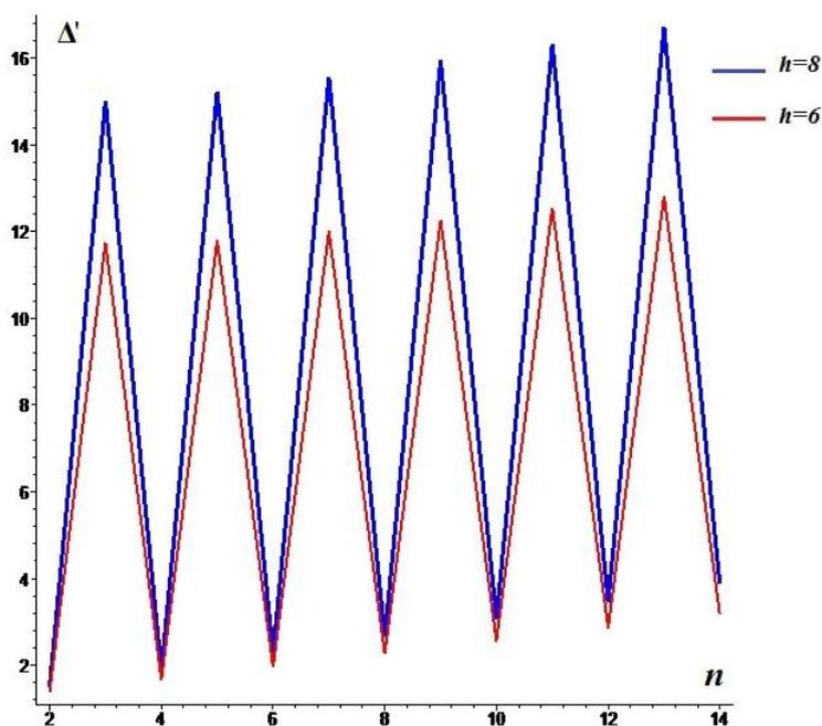
Рисунок 2 – График зависимости прогиба от числа панелей
