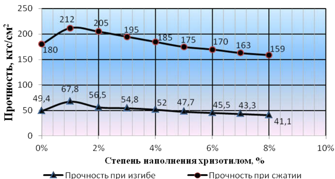
Рисунок 3 – Зависимость прочности при изгибе от степени наполнения бетонной смеси хризотилом в присутствии суперпластификатора Melflux 5581.
