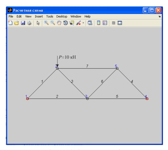
Рисунок 1 – Расчетная схема фермы
