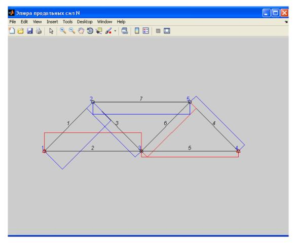
Рисунок 3 – Эпюра продольных сил на экране монитора
