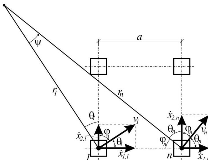
Рисунок 2 – Определение угловой скорости яруса
