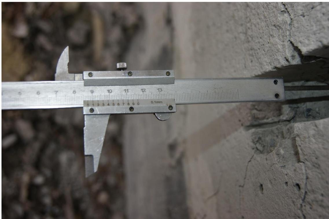
Рисунок 1 – Глубина усадочной трещины при ширине раскрытия 3 мм
