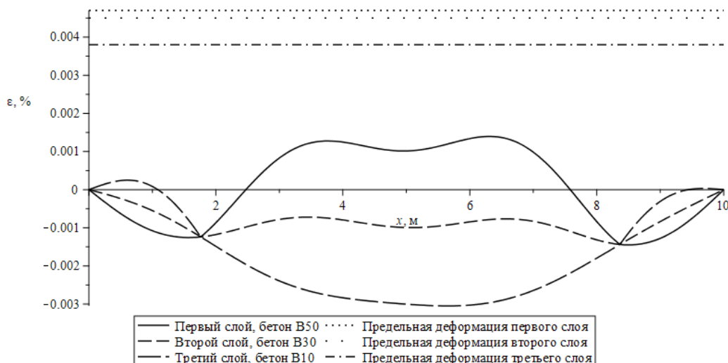
Рисунок 31 – Распределение деформации материалов на верхних контактных границах слоев по длине стержня (конструкция №7, g_x = -9,81 \text{ м/с}^2, g_z = 0 )
