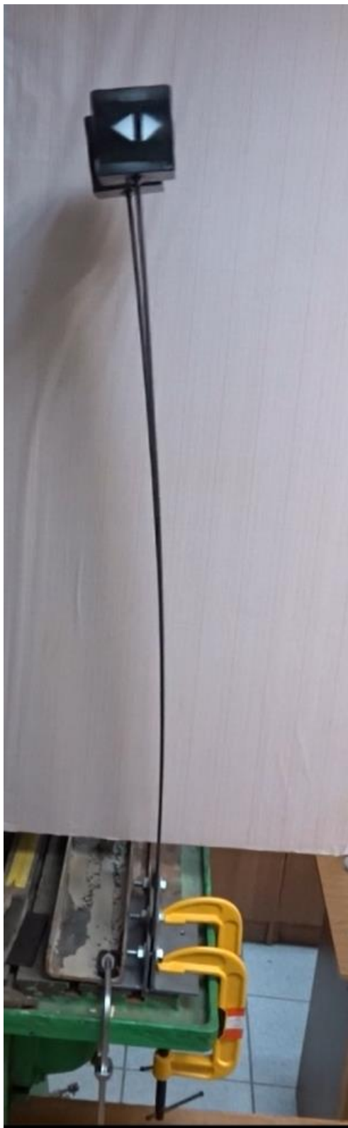
Рисунок 2 – Колебания без накладок (практически одинаковые амплитуды и частоты)
