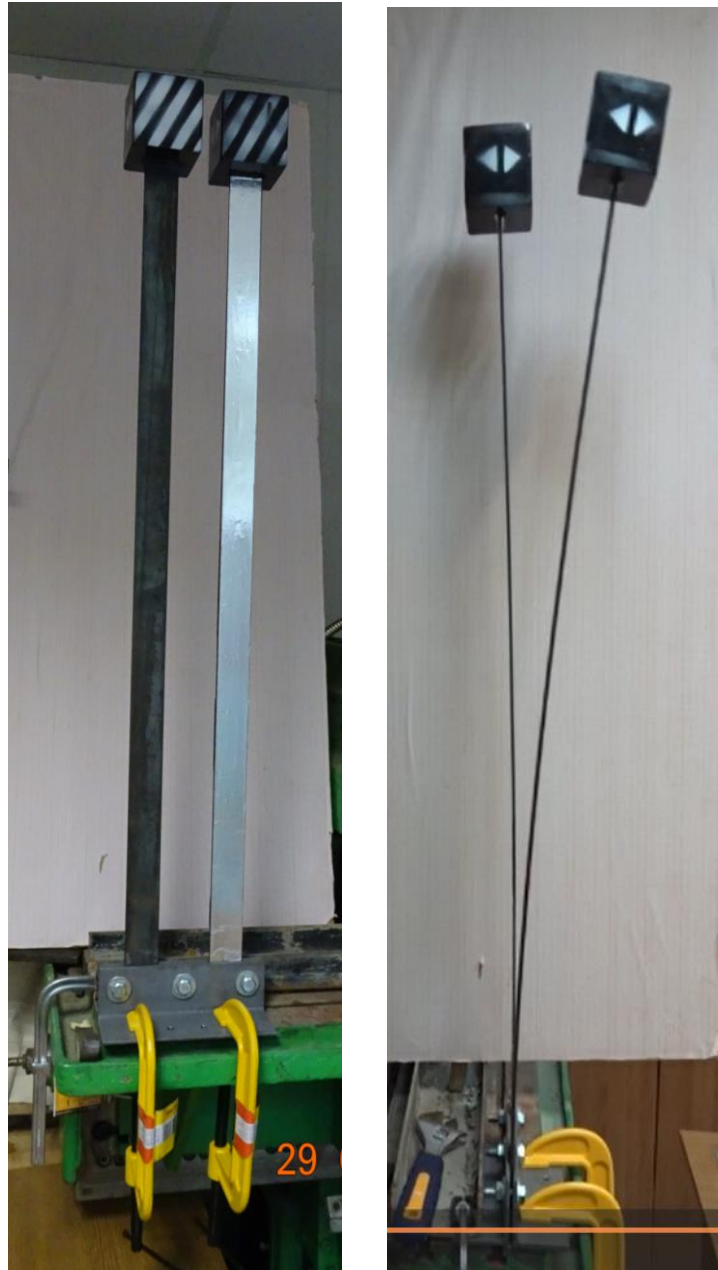
Рисунок 3 – Колебания с накладками (наклеено 75 мкм с каждой стороны на правую (при снятии отсчетов – дальнюю) от наблюдателя стальную полосу).
