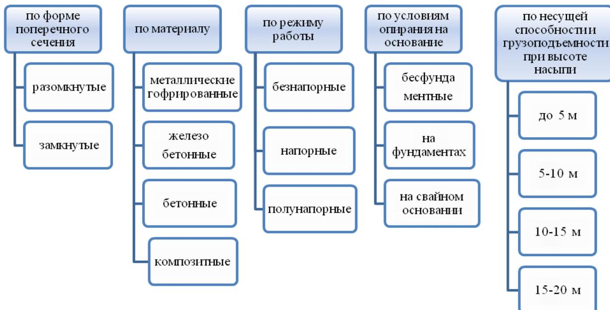
Рисунок 1 – Классификация водопропускных труб
