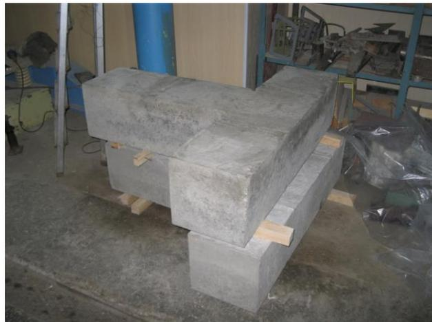
Рисунок 4. Общий вид опытных образцов узлов сопряжения колонн крайнего ряда с балками
