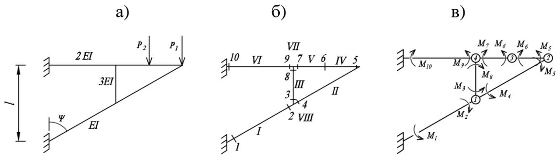
Рисунок 1 - Расчетная схема рамы и её дискретная модель
