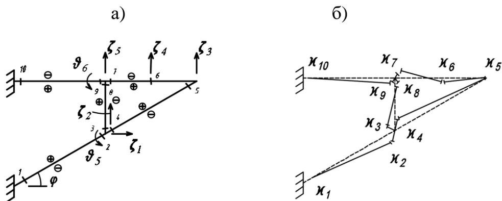
Рисунок 2 - Независимые перемещения узлов и схема сосредоточенных изгибных деформаций рамы
